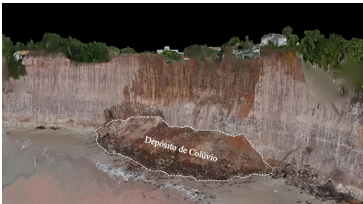
FIGURA 8: Representação tridimensional a partir de nuvem de pontos LiDAR do depósito de colúvio na base da falésia.
