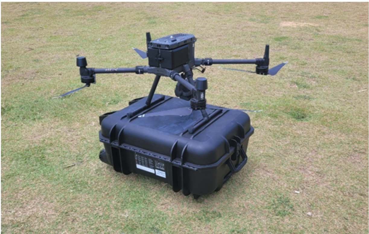
FIGURA 2: ARP DJI Matrice 300 RTK acoplada do sensor L1 (LIDAR).
