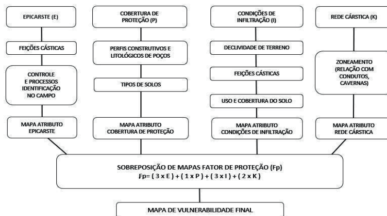
Figura 3. workflow metodológico para integração dos parâmetros de vulnerabilidade aquífera EPIK
