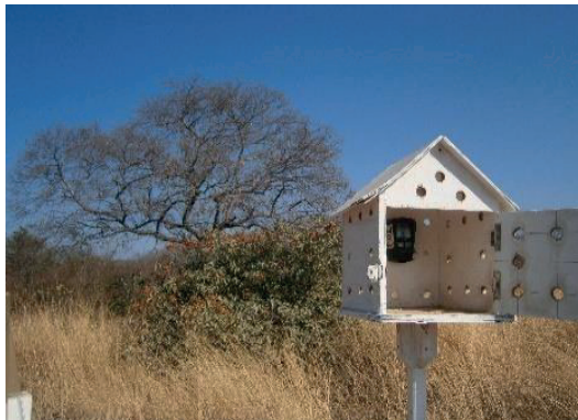
Figura 02. Termohigrômetro digital acoplado a abrigo meteorológico de madeira
