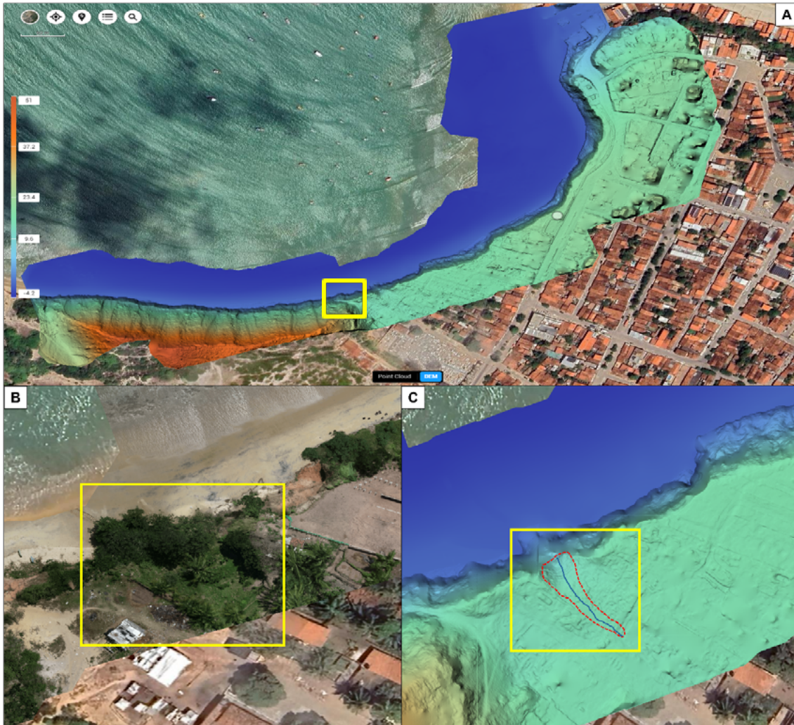
Figura 11: A – Modelo Digital de Elevação com o filtro que remove a vegetação; B – detalhe da borda da falésia recoberta pela vegetação em uma imagem de satélite no canal do visível; C – Ravina identificada no MDE, só visível com o emprego do filtro que remove a vegetação.
