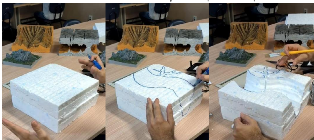
FIGURA 1 - Processo de elaboração de maquetes em isopor.
