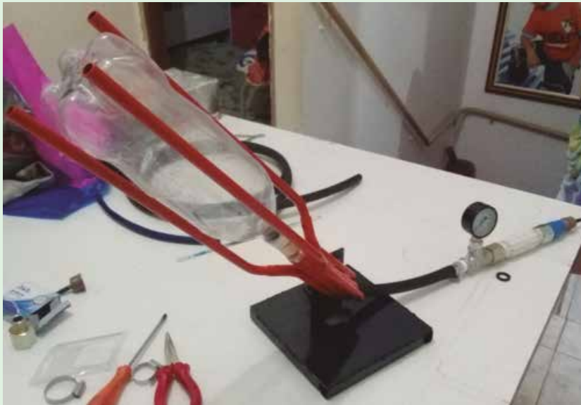
Figura 1.1. Foto da base de lançamento de foguete de propulsão à água desenvolvido para o Kit Didático de Ensino de Física.
