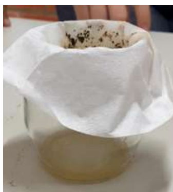
Demonstração da separação da água e da areia através da filtração com o filtro de papel.
