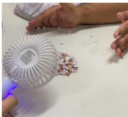
Demonstração da separação do feijão e das bolinhas de papel através da ventilação.
