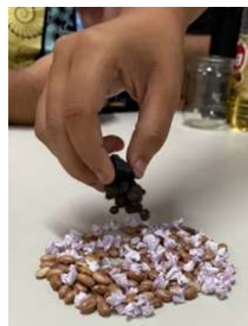
Demonstração da separação magnética das bolinhas de palha de aço dos outros materiais com o auxílio de um ímã.
