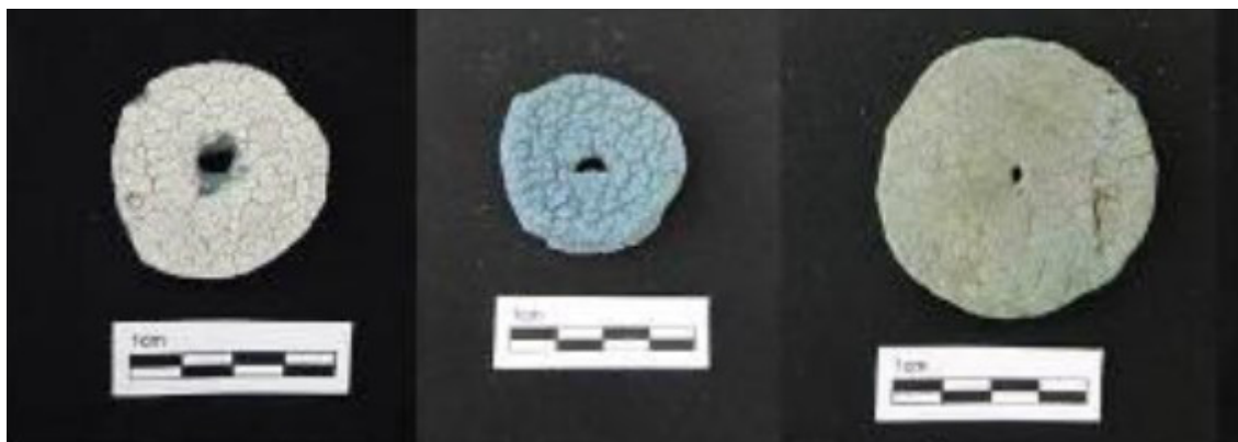
Figura 10 – Rodinhas de borrachas produzidas a partir das solas de sandálias ou chinelos de borracha
