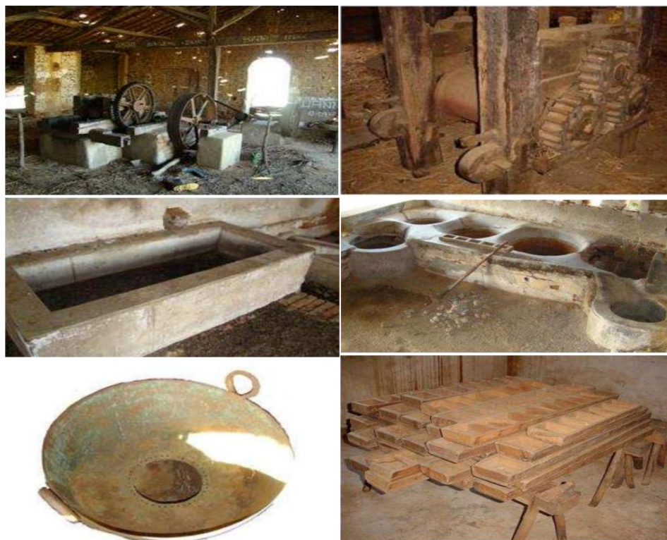
Figura 08 – Instrumentos utilizados para o preparo da rapadura, com destaque para a moenda, o parol, a alvenaria onde se realizava o cozimento com fogo a lenha, o tachó e as formas da rapadura
