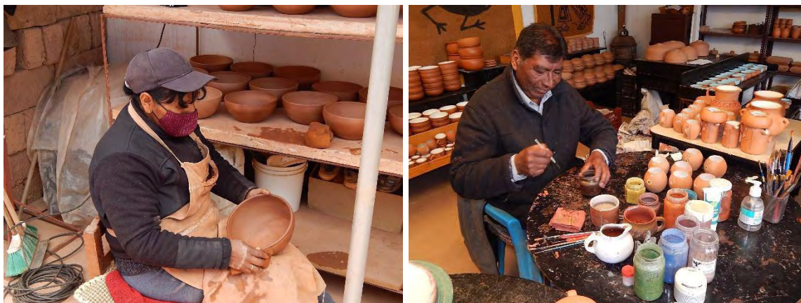
Figuras. 8 y 9 - Proceso de lijado y de pintado artesanal de las piezas.
