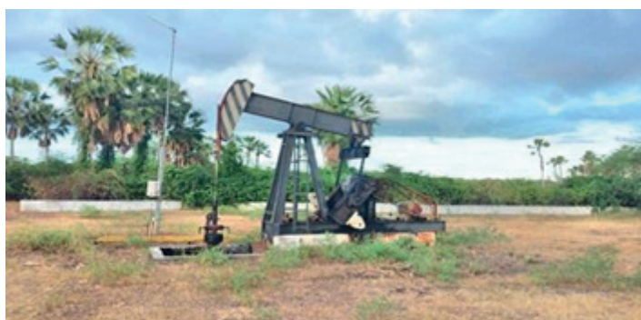
Figura 8: Extração de petróleo com os cavalinhos
