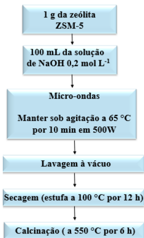
Figura 11 -Fluxograma da hierarquização da ZSM-5 por tratamento alcalino.
